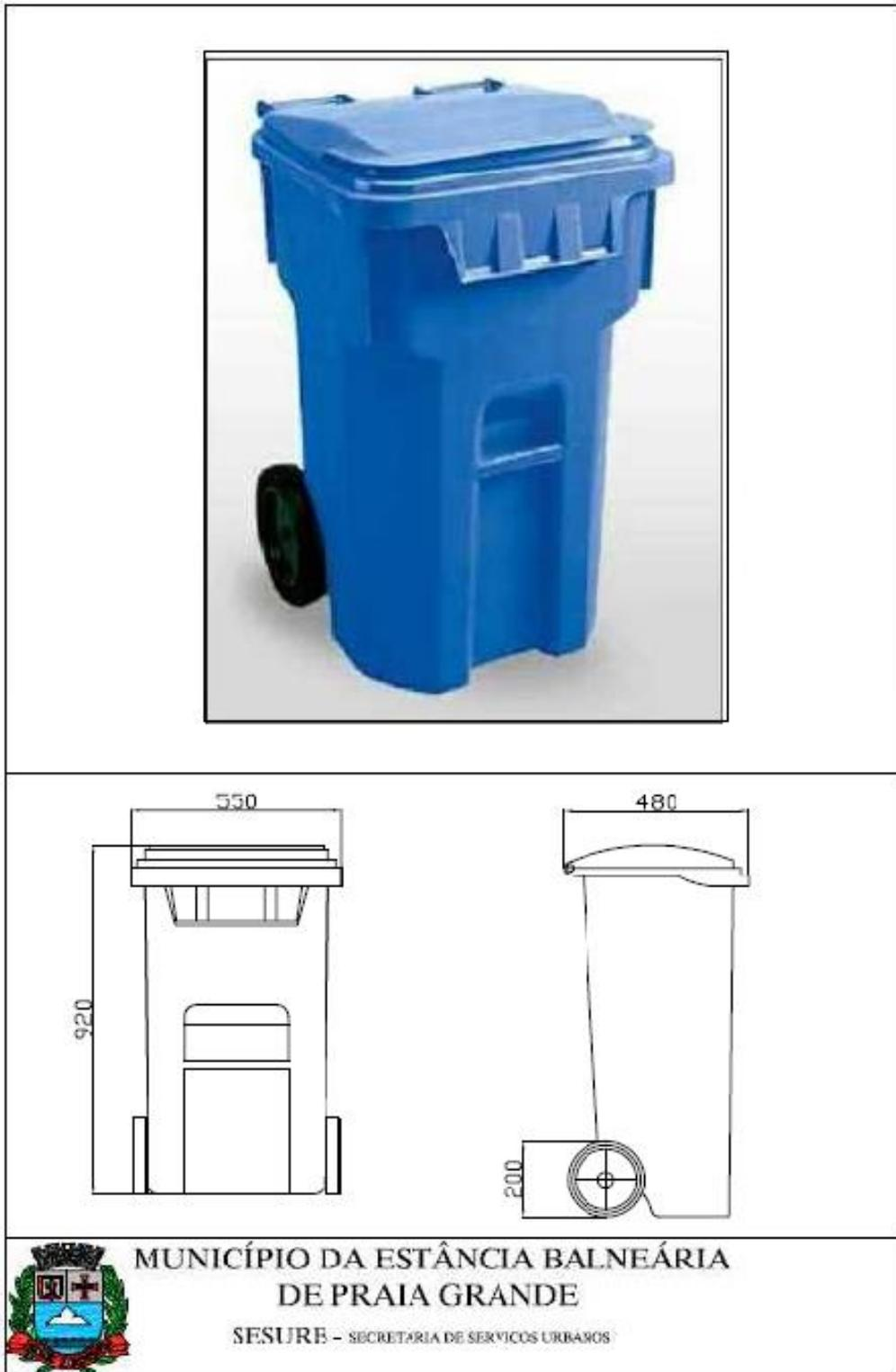
Figura 6.2.2- 4: Contentor para coleta de varrição de logradouros públicos (RLU)
