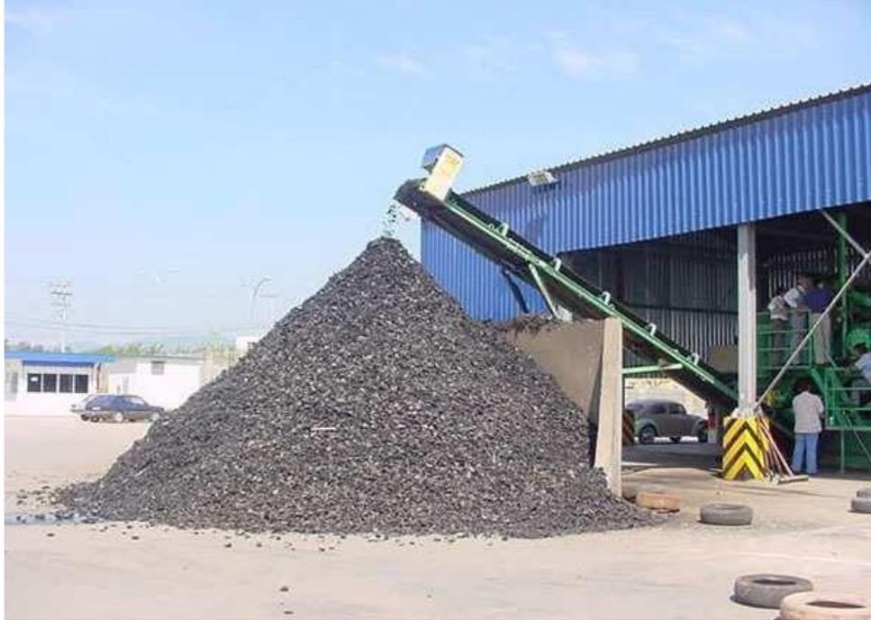
*Figura 6.6.2- 3: Borracha triturada dos pneus*
