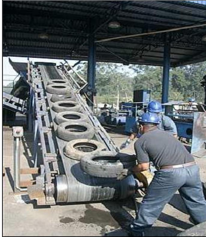
*Figura 6.6.2- 1: Figura 6.7.2-1 – Esteira para o triturador*
