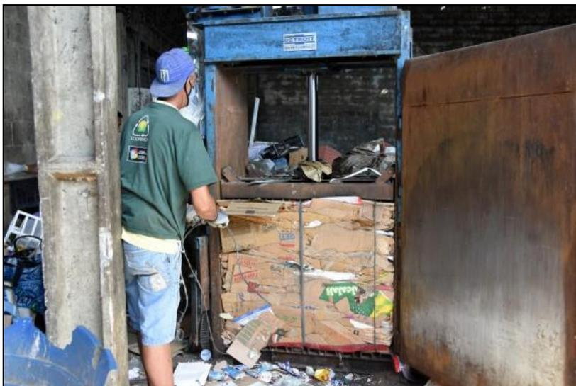
*Figura 4.3.5- 3: Galpão de triagem – Detalhe da compactadora de papel reciclado*
