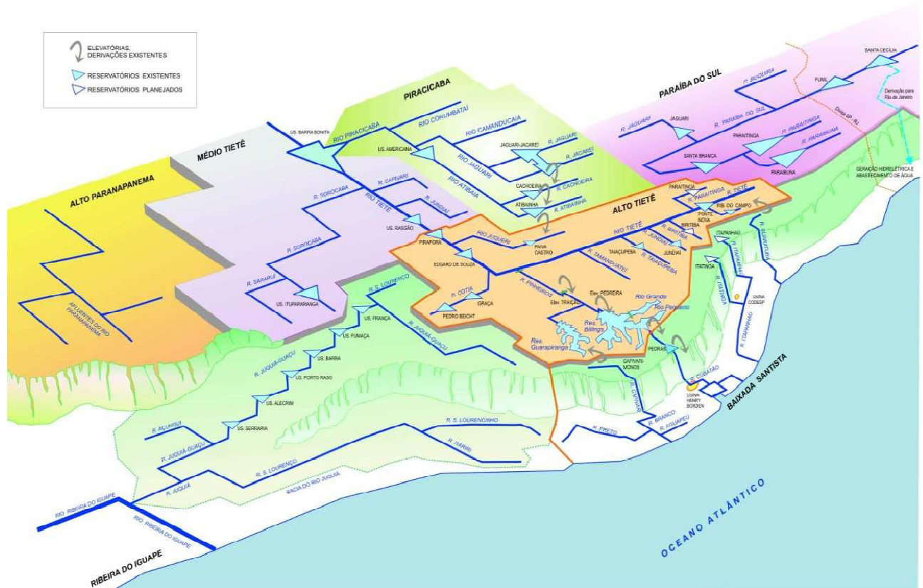
Figura 10 – Esquema hidrológico da Macrometrópole Paulista (MMP) e vinculações hídras existentes entre as Unidades de Gerenciamento de Recursos Hídricos 5 - Piracicaba/Capivari/Jundiá, 6 - Alto Tietê e 7 - Baixada Santista
